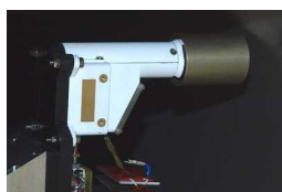
Figura 3: Uno de los modelos de vuelo de TWINS durante los ensayos de calibración del sensor de temperatura del aire. El sensor de viento está cubierto por su protección de seguridad. Créditos: CAB.
