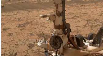
Figura 3: Imagen del mástil de Curiosity con parte de los sensores de REMS tomada en abril de 2015. Créditos: NASA/JPL-Caltech/MSSS.
